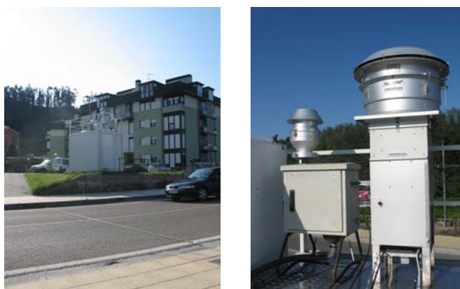
Figura 3. Vista de la estación de muestreo de Barreda (imagen izquierda) y detalle de los dos captadores gravimétricos de \text{PM}_{10} (ANDERSEN, derecha) y \text{PM}_{2.5} (MCV, izquierda) en la imagen de la derecha.
